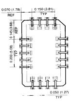
20-PIN PLASTIC ZIGZAG-IN-LINE PACKAGE
